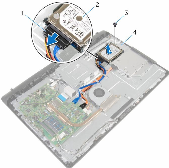
1 καλώδιο τροφοδοσίας και δεδομένων 2 διάταξη σκληρού δίσκου
